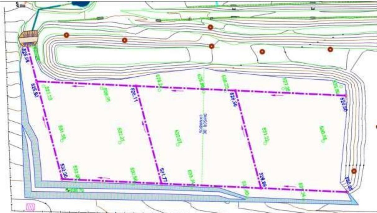
Figura 5-1. Sistema de drenagem de base de águas limpas (em lilás e cotas em azul), saída das águas limpas sob o dique (em verde água) e cotas da terraplenagem de base – corte e aterro (em verde claro).
